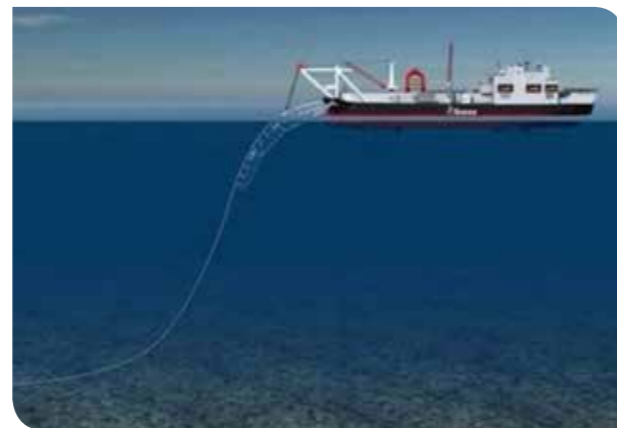
2. attēls. S veida cauruļvada likšana, izmantojot dinamiski pozicionētu (DP) cauruļlicēju kuģi (Allseas.com, 2013)
