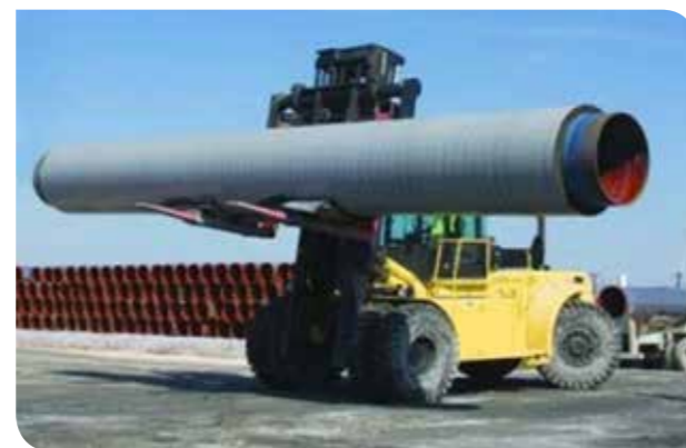
3. attēls. Caurules posms ar polietilēna (PE) pārklājumu (melnā krāsā) zem betona pārklājuma, ko izmanto atsvaram
